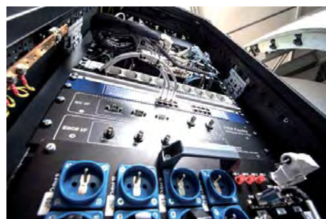
Special Check-Out Equipment (SCOE) für den Erdbeobachtungssatelliten Jason-CS. Foto: RST
