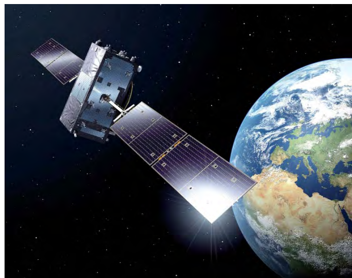
Die Galileo-Satelliten befinden sich in mittleren Umlaufbahnen in 23.222 km Höhe auf drei Bahnebenen. Foto: ESA-P. Carril
