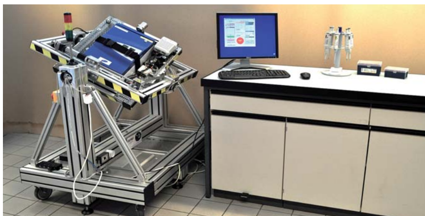
Schwerelosigkeitssimulator (Random Positioning Machine) des «Nationalen Zentrums für Biomedizinische Weltraumforschung», der eigens für die Langzeit-Kultivierung von Säugetierzellen und Gewebe gebaut wurde. Foto: HSLU
