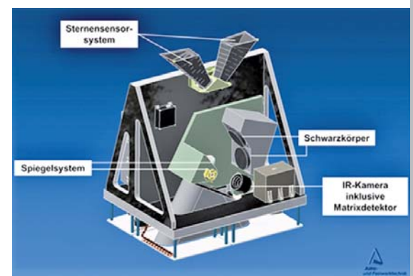
3D-Darstellung des DIEGO-Sensorsystems
