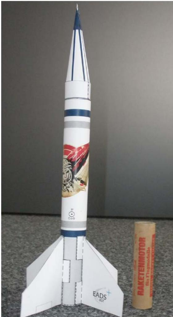
12. Als letzter Schritt folgt das Trimmen der Rakete. Dies ist für den Flug der Rakete sehr wichtig. Dazu wird mit etwas Knete der Gewichtsschwerpunkt der Rakete eingestellt. Unterhalb des „Tag der Raumfahrt“ Logos findet ihr eine Markierung SP. Mit einem Zwirnsfaden wird eine Schlaufe geknotet und diese genau im Schwerpunkt der Rakete befestigt. Jetzt wird solange Knete in die Raketenspitze gedrückt, bis die Rakete mit installiertem Raketenmotor waagrecht hängt.
